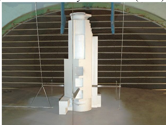
Рис. 2. Макет здания в аэродинамической трубе
