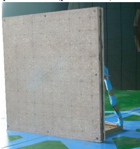
Рис. 8. Модель НФС с вентилируемой прослойкой и проницаемым внешним ограждением (вид спереди)
