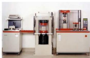
**Испытательная машина ( испытание на сжатие и изгиб) ToniPRAX для призм и кубических образцов по EN 196, ISO 679, ASTM C 109 и C 349**
