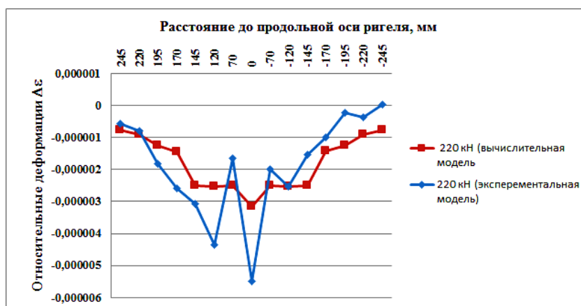
Рисунок 10 – Относительные деформации вдоль ригеля в зоне сопряжения с плитами экспериментальной и вычислительной моделей
