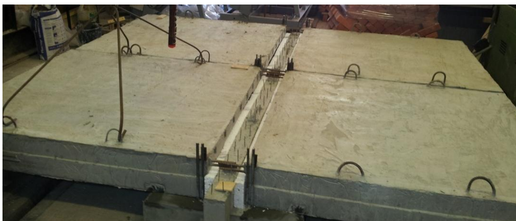
Рисунок 3 – Модель сопряжения плит с ригелем
