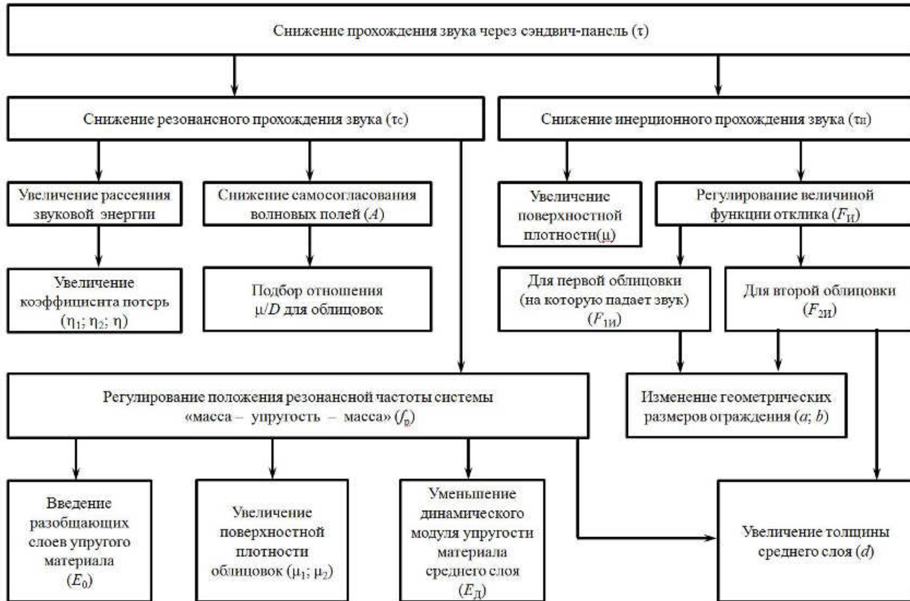
Рисунок 3.5 – Способы повышения звукоизоляции сэндвич-панелей
