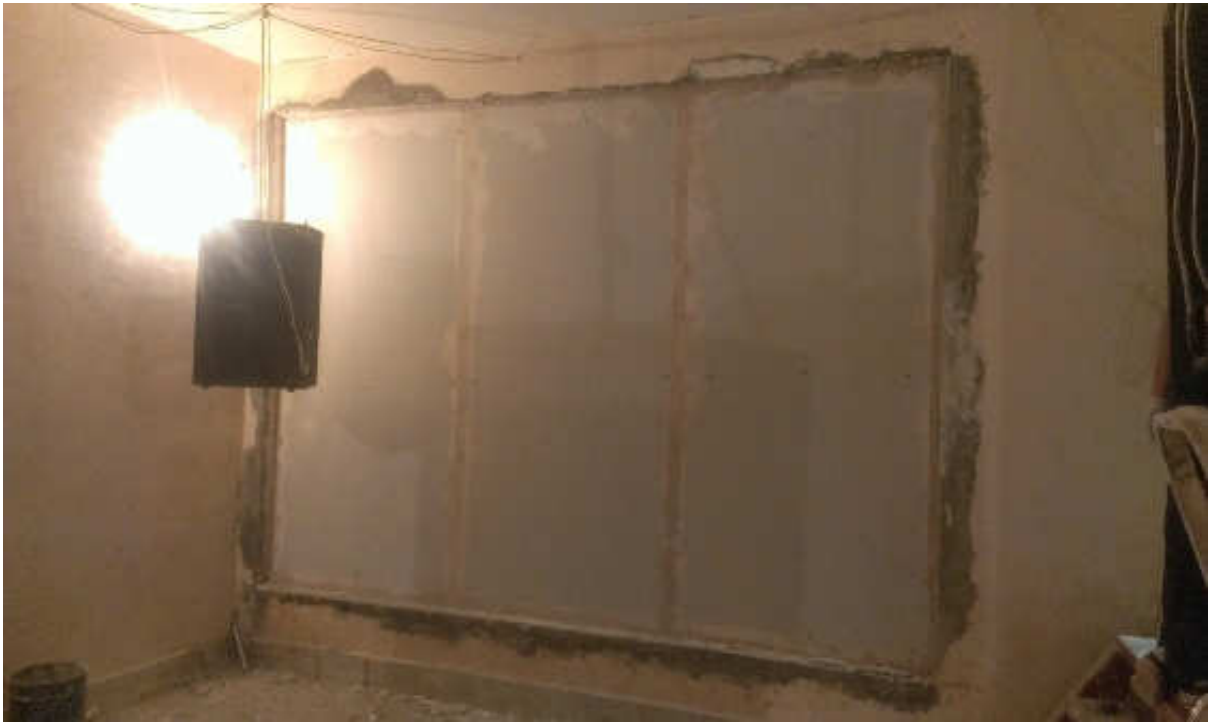
Рисунок 5 – Образец сэндвич-панели размером 3,6 м × 2,5 м установленный в проеме реверберационных камер лаборатории акустики ВоГУ
