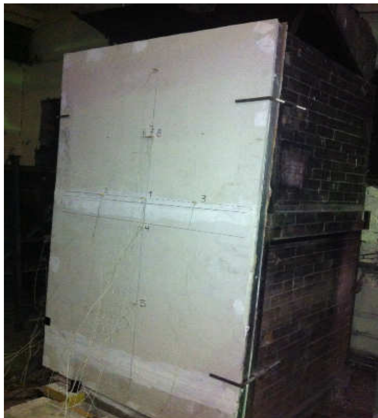
Рисунок 4 – Образец сэндвич-панели установленной в печи для испытания вертикальных конструкций на пожарную опасность
