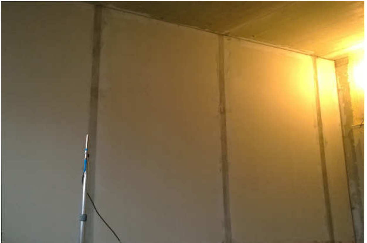
Рисунок 7 – Перегородка (размер 3,9 м × 2,5 м) из сэндвич-панелей при испытаниях ее звукоизоляции в натуральных условиях.
