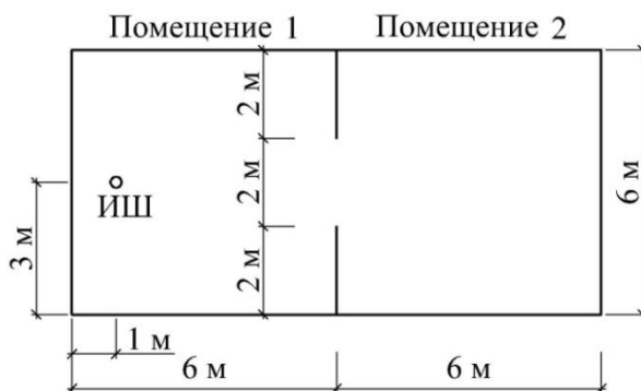
Рисунок 2.6 - Схема двух акустически связанных помещений для примера 3
